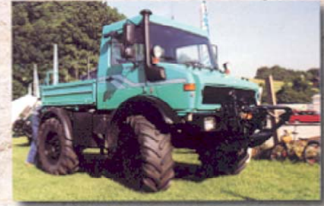
Komfortables Arbeiten: Unimogs mit großer Kabine und Fronthydraulik.
