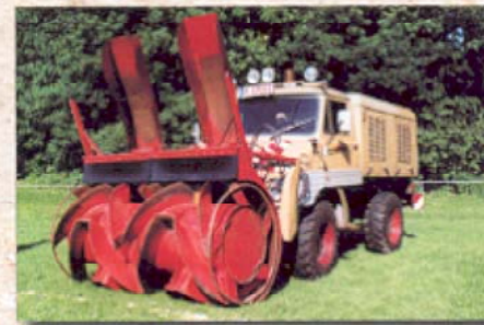
Gewaltig: Unimog mit Schneefräse und 150-PS-Steyr-Diesel.
